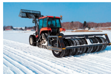
冬場に凍結する北海道の土壌は、ローラーで雪を圧縮して土の中に封じ込めることで、有害な菌が死滅し、雑草が根ごと枯れ、土もやわらかくなる。気象条件を生かした土づくりが行われている
