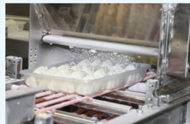
餃子の上に粉を振りかけた後、ラインを通り急速冷凍されます。30分後にはカチカチの状態になっています
