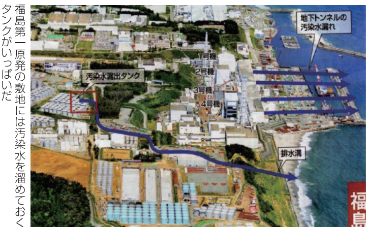
福島第一原発の敷地には汚染水を溜めておくタンクがいっぱいだ
