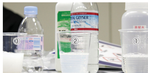
水の硬度によるせっけんの溶け方実験
