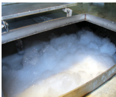
②水酸化カリウムの水溶液にオレイン酸を入れ攪拌
