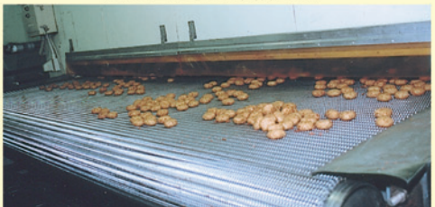
トンネルフリーザー
