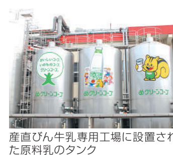
産直びん牛乳専用工場に設置された原料乳のタンク
