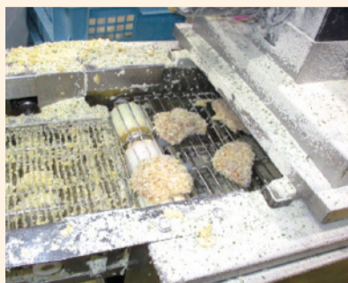
つなぎには添加物を使わないため、肉にパン粉を定着させるローラーの重さを調整している。
