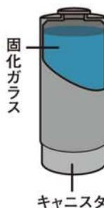
放射能の高い廃液をガラス原料と融かし合わせてステンレス製容器（キャニスター）の中で固めます。
