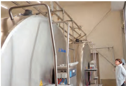
生乳が17トン入るバルククーラー（冷却保存タンク）。自動洗浄で常に清潔です。
