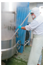
より良い佃煮を作るために作った、釜の中の昆布を混ぜるためのオリジナル調理器具。昆布を載せて状態をみているようす
