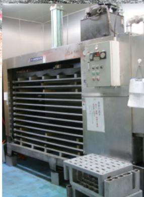
温水解凍機。冷凍すり身をプレスしながら解凍する。40分ほどで半解凍になったものを、ボールカッター(真空状態で低温のまま短時間で練る)に入れて練り上げていく
