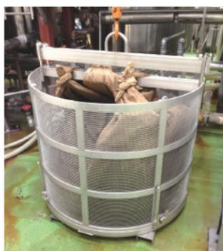
②かつお節と昆布を布袋に入れ、クレーンで吊った籠にセットして、大釜への投入準備が完了
