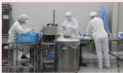
製造した乳液は、ステンレス容器に取り出され、検査を受け、安定化させてから一つひとつ手作業で容器に充てんする。乳液であれば通常一日約5000本までを製造
