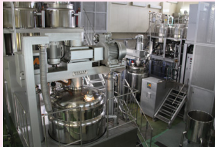
真空釜の中にあるタービンを高速回転させることで、水と油である原料を乳化させる
