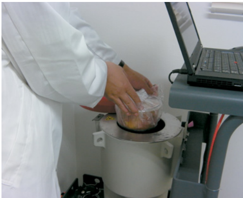
放射能検査機器CJ-NAI食品・放射能測定装置(キャンベラジャパン(株)製) 自主基準10ベクレル/kgを正確に測定することができる性能を備えています
