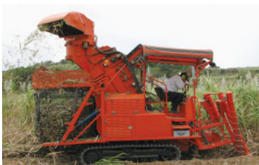
ハーベスターでまたたく間に刈り取る。後部では裁断された砂糖きびがネット詰めされる
